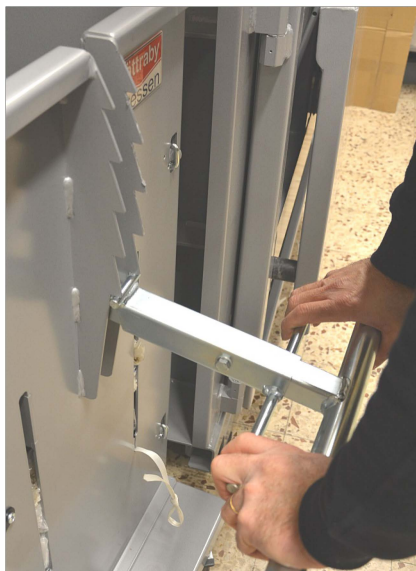
Pressepladen stopper i nederste position og presser luften ud, hvilket giver kompakte baller. Den smarte belastning kan nemt løsnes.
