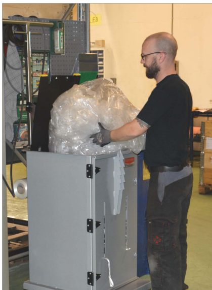
Fyld materialet ovenfra, og lad pressepladen falde ned.
